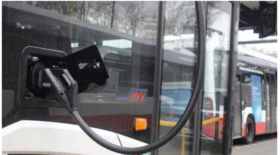
Bei der Hamburger Hochbahn AG entstand in einem Pilotprojekt die VDV 463-Schnittstelle.
